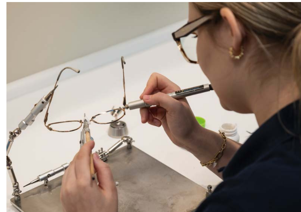
Lottes zerbrochene Brillenfassung wird hartgelötet.
